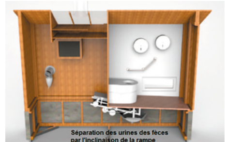
Dispositif à séparation des urines et des matières (Sanisphère®)
